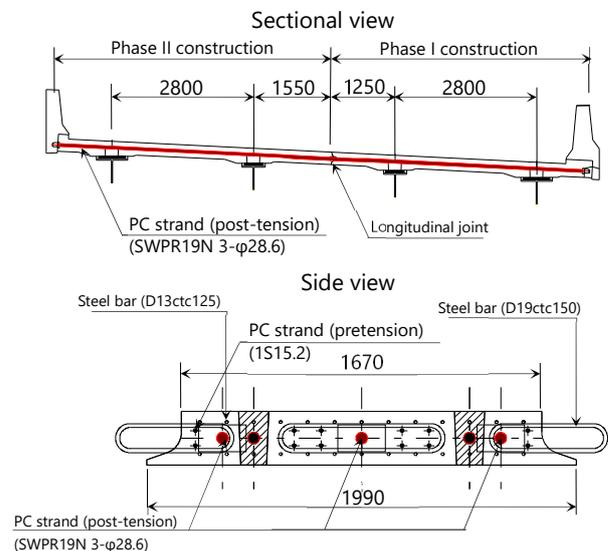
Fig. 4 Precast PC slab
