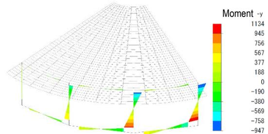
Fig. 8 Cofun C: seismic bending stress (kNm)
