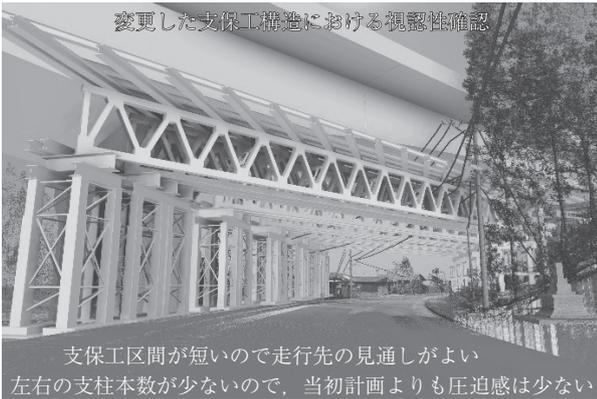
図 - 9 支保工構造の違いによる走行車両の視認性の確認
