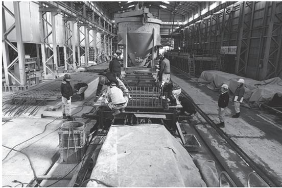
写真 - 2 PCaPC 床版（工場）製作状況
