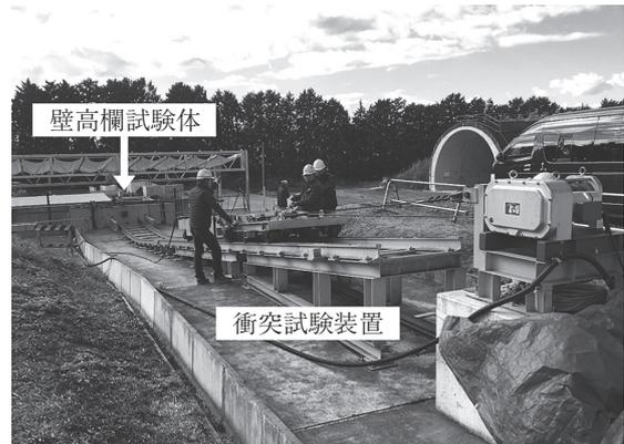
写真 - 1 PCa 壁高欄性能確認試験状況
