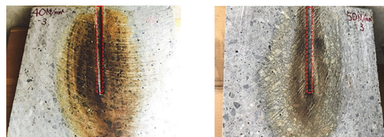
試薬噴射後（39.5 N/mm 2 ） 試薬噴射後（51.6 N/mm 2 ） 写真 - 7 高強度供試体切断面（高圧力装置使用）
