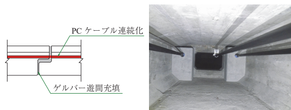
図 - 2 外ケーブルによる連続化
