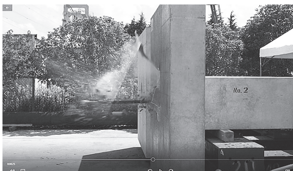
写真 - 3 鉛直 PC 鋼棒突出実験
