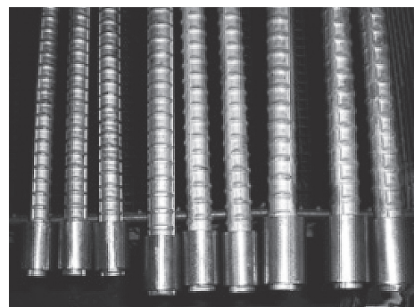
写真 - 3 ステンレスエンドバンド鉄筋 (D16, D19, D22)
