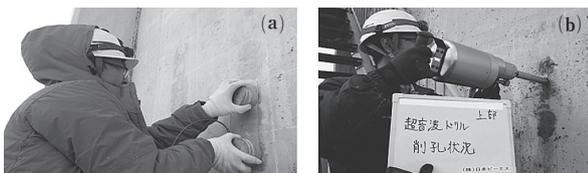
写真-2 調査状況 (a)広帯域超音波法・(b)削孔調査
