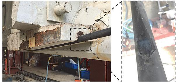
写真-6 新調ケーブル緊張による被覆材損傷の再現
