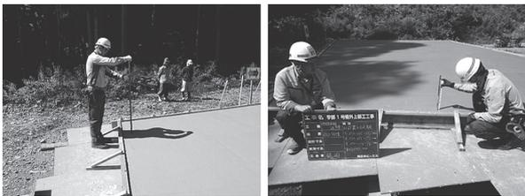
写真 - 5 N式貫入試験実施状況
