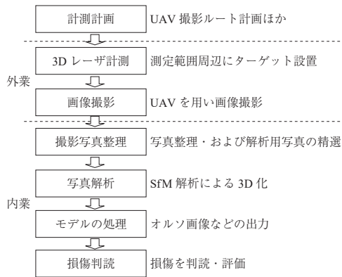
図 - 2 UAV-SfM 計測システム作業のフロー
