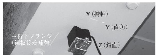
写真 - 2 高感度 3 軸加速度センサー
