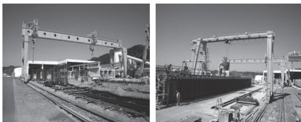
(a) 製品移動、積込み用クレーン (b) 製作用クレーン
