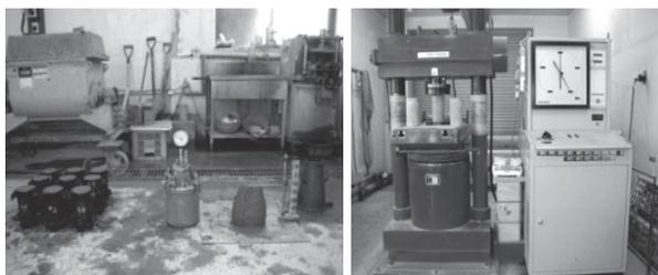
(a) スランプ、空気量試験 (b) 圧縮強度試験
