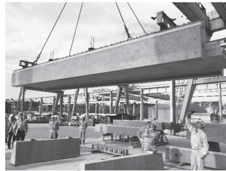
写真 - 6 スパン梁製品検査状況
