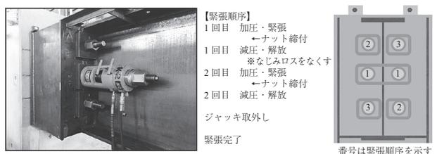
図 - 17 プレストレス導入確認実験の概要
