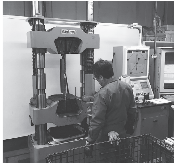
写真 - 5 載荷装置
