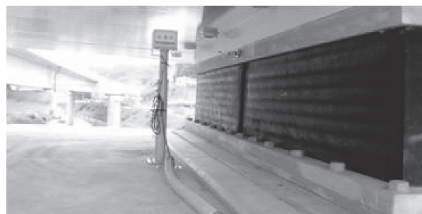
(b) 支承の変位計測状況
