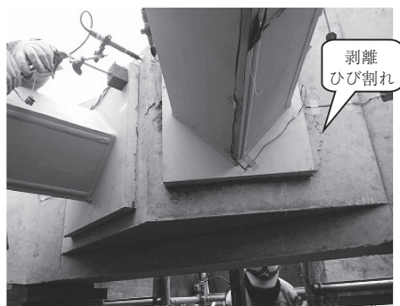
写真-5 荷重試験後の供試体状況
