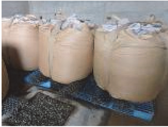
写真 - 6 廃瓦細骨材の水切り状況
