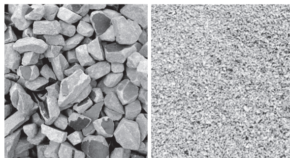
写真-4 廃瓦骨材（左：粗骨材，右：細骨材）
