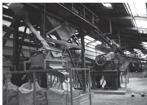
写真-2 規格外瓦の破砕機
