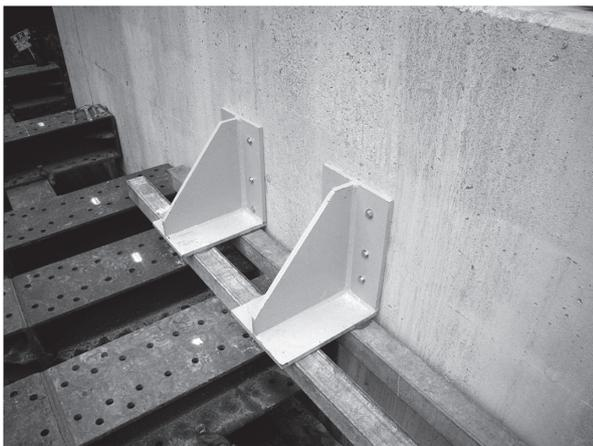
写真 - 2 反力ブラケット設置状況
