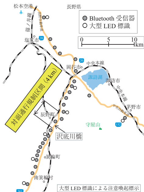
図 - 13 渋滞計測システムの配置図
