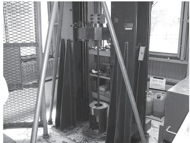
写真 - 6 中間定着具の性能試験
