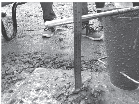
写真 - 6 スランプ試験結果 (20.0 cm 以上 : 不合格)
