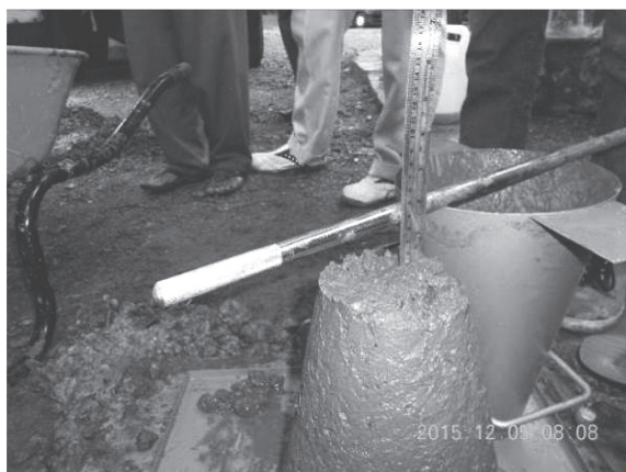
写真 - 5 スランプ試験結果 (3.5 cm : 不合格)
