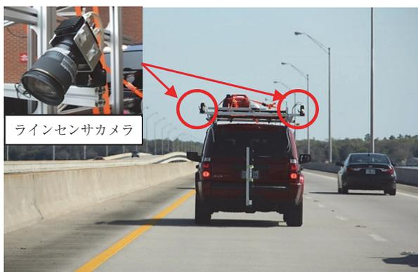
写真 - 3 ラインセンサカメラによるコンクリート床版の撮影
