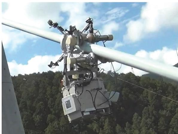
写真 - 9 自走式点検ロボットの一例
