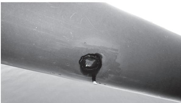
写真 - 3 充填材注入口の割れ
