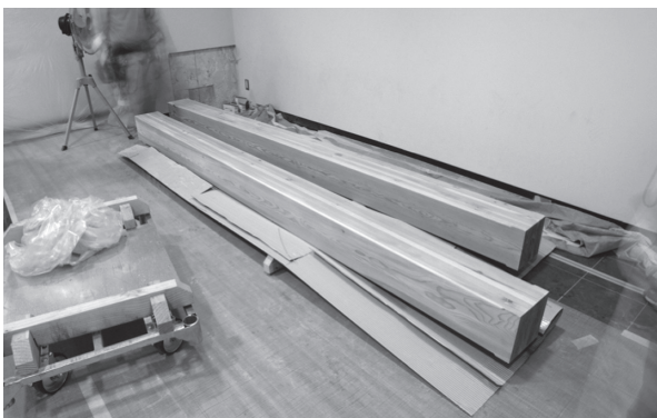
写真 - 4 ブレース軸材 バイマツ集成材 210 角
