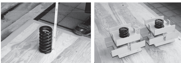
(a) コイルばね形状 (b) 下端鉄骨部組立て状況
