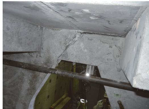
写真 - 3 上床版の接合部の破壊状況
