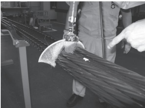
写真 - 8 ピンホール試験状況
