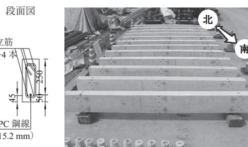
写真 - 1 PC 梁試験体
