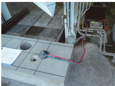
写真-6 表層透気試験状況
