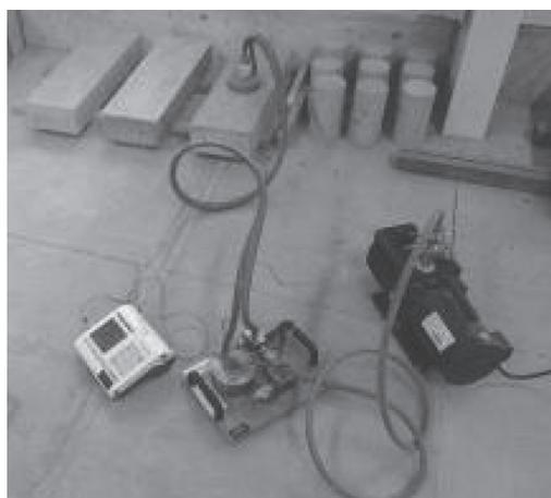
写真 - 7 透気係数計測状況 (材齢28日)
