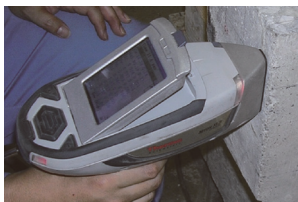
写真 - 6 蛍光 X 線による塩化物イオン計測
