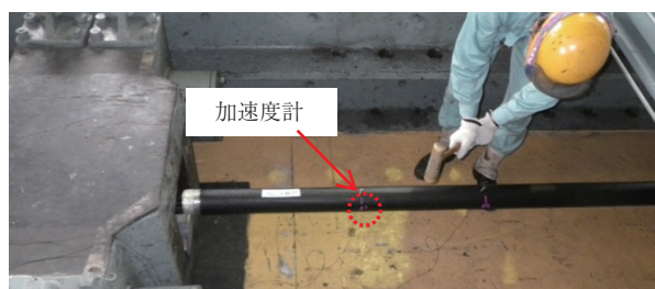
写真 - 2 ハンマー打撃加振
