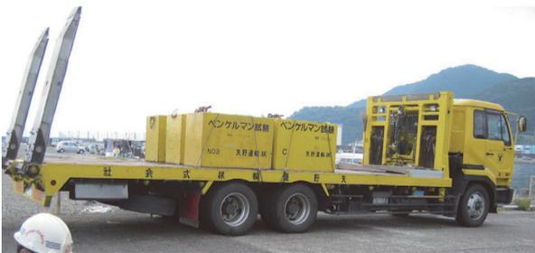
写真 - 1 荷重試験車 (バンゲルマン試錘搭載車 -20 t)
