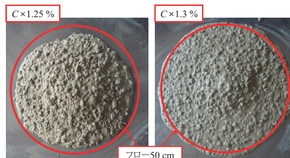
写真-2 中流動コンクリートのスランプフロー
