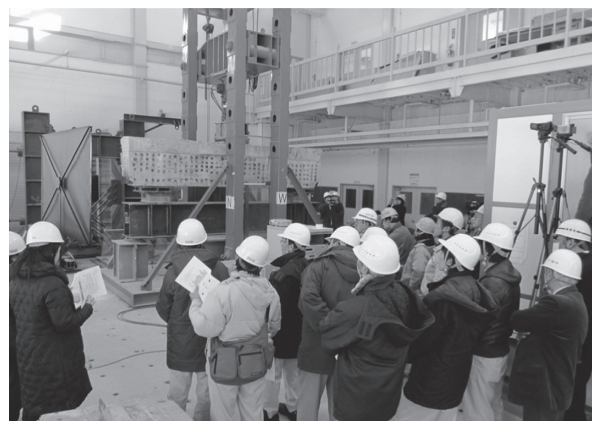
図-4 RC 撤去桁の載荷試験（公開実験）
