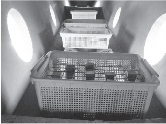
写真 - 2 箱桁内における UFC 供試体の暴露状況
