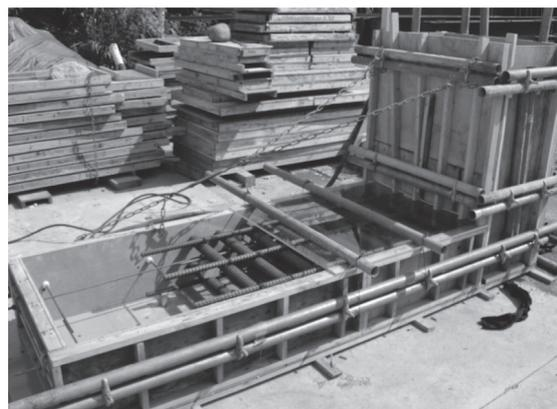
写真 - 6 コンクリート充填確認実験状況
