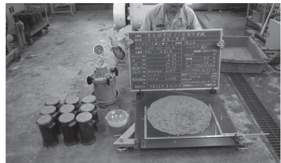
写真 - 8 フレッシュコンクリート試験（60-60-20H）
