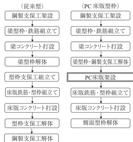
図 - 7 施工フロー図
