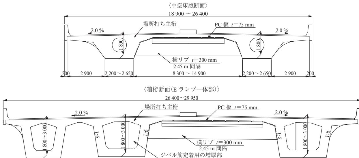
図 - 3 上部工断面図
