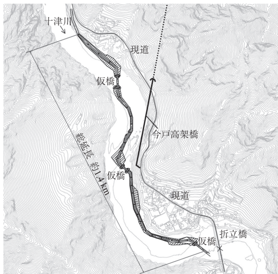
図 - 14 工事用道路
