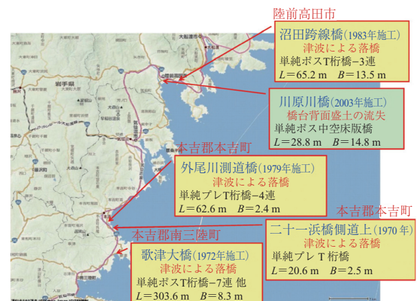
図 - 7 南三陸地区における国道 45 号の PC 橋の被災状況
