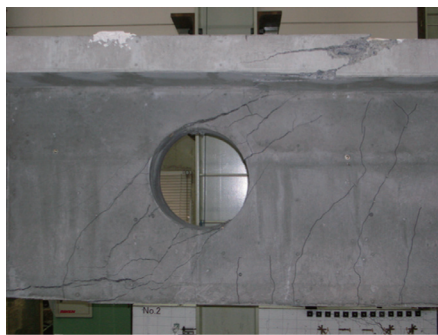
写真 - 2 開口部最終破壊状況
