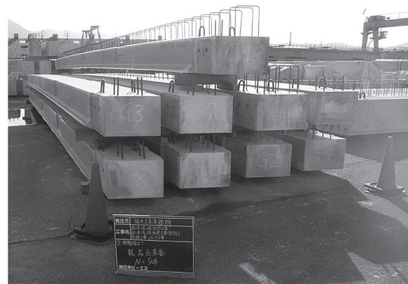
写真 - 5 主桁完成写真（山王3号橋）
