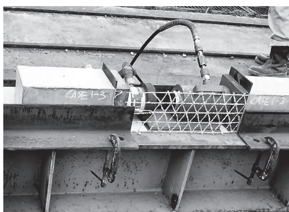
写真 - 14 一軸付着引張試験状況 (3軸アラミドメッシュ)
