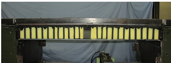
写真 - 3 伸縮試験状況 (遊間 1 334 mm)
