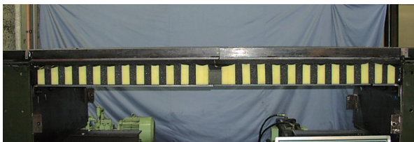
写真 - 2 伸縮試験状況 (遊間 1 964 mm)
