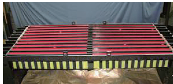
写真 - 5 水張り試験状況 8 時間経過後 (遊間 1 964 mm)
