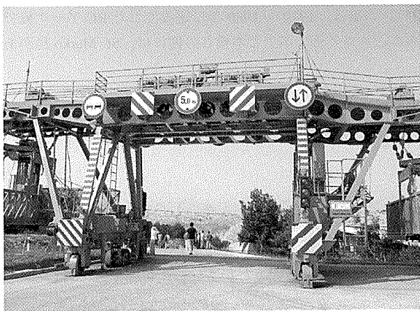
写真 - 22 補修作業車
