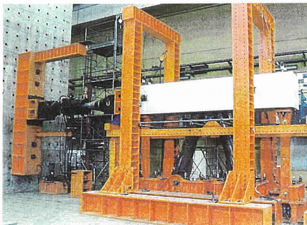
写真-6 格点構造の実物大模型実験
