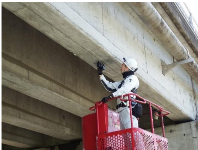
写真 超音波計測機による現地測定状況
