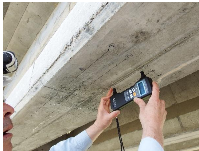
写真 超音波計測機による現地測定状況
